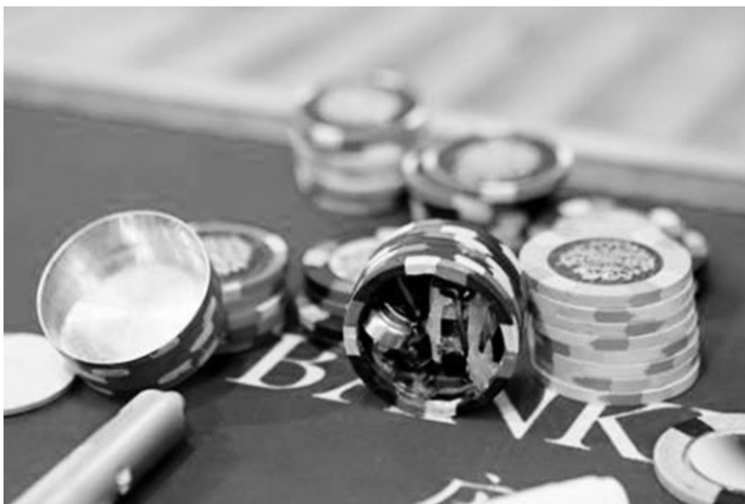
图37 伪造筹码中的摄录装置
