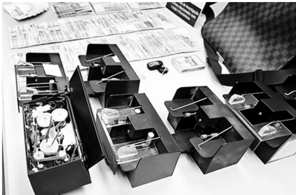
图36 假冒洗牌机中的摄录装置〔237〕
